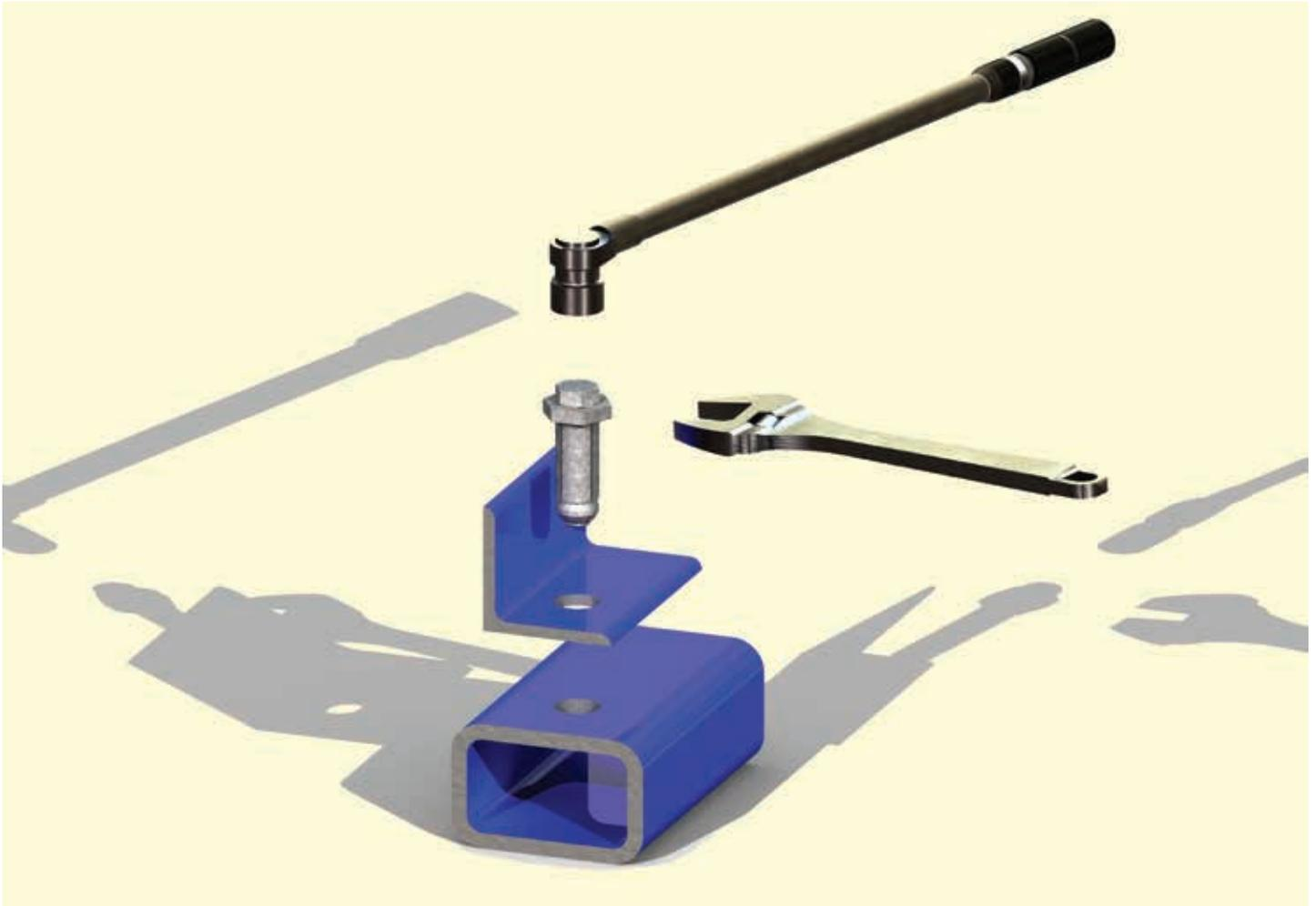
**ÉTAPE 1:** Percer les profils à fixer en respectant le diamètre et l'écartement des trous. Ebarber les trous. Aligner les trous. Insérer le **BOXBOLT** à travers les deux pièces d'acier et vérifier que le collier repose à plat sur le profil et ne présente pas de jeux.
