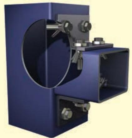
Profil creux et profil creux, raccordés par une équerre
