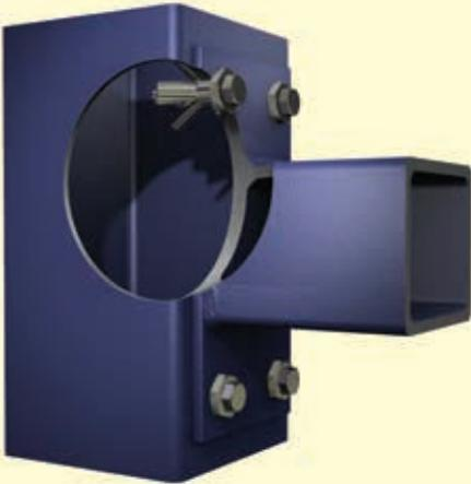
Profil tubulaire avec une plaque de bout, accordé à un profil creux vertical
