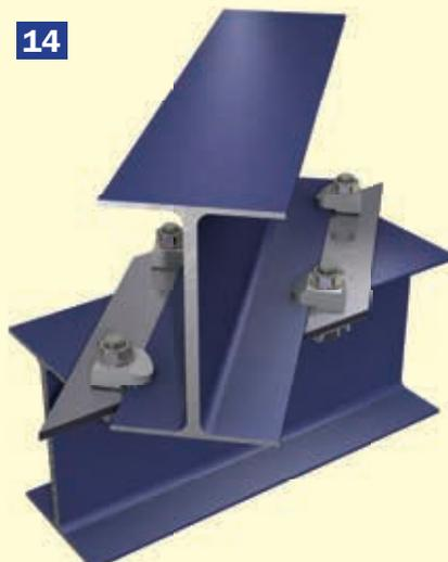
Vue de dessus de deux poutrelles se croisant avec un angle différent de 90°
