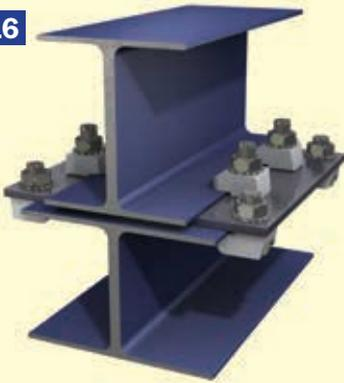
Poutrelle contre poutrelle, de largeurs différentes, en parallèle
